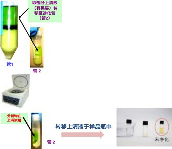
取部分上清液 (有机层) 转移至净化管 (管2)
